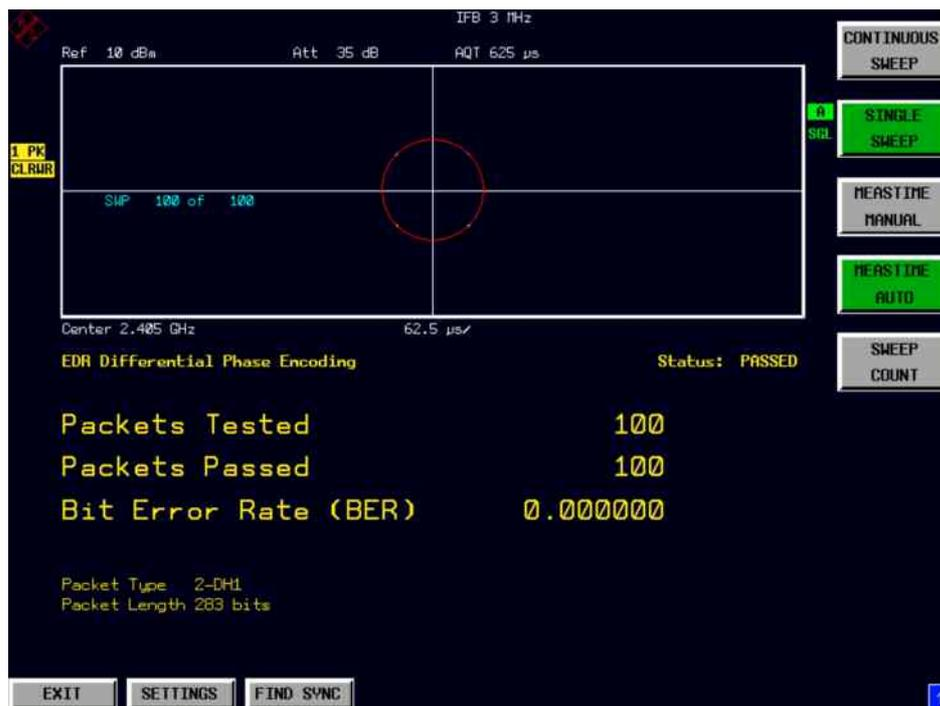
Bild 16 Differential Phase Encoding-Messung (EDR)
