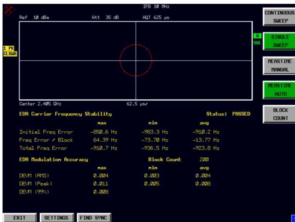
Bild 15 Trägerfrequenzstabilitäts- und Modulationsgenauigkeitsmessung (EDR)
